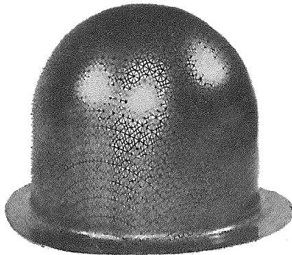
Sl.3. Otpresak korišćen pri ispitivanju maziva
